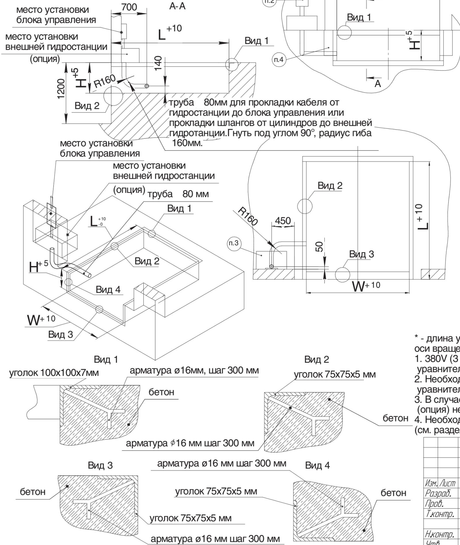
На данном эскизе изображена схема подготовки приямка и установки закладных элементов под уравнильную платформу с поворотной аппаратурой встроенного типа длиной\* 2500мм шириной 2000мм и высотой 600мм при использовании автомобилей без встроенного лифта
